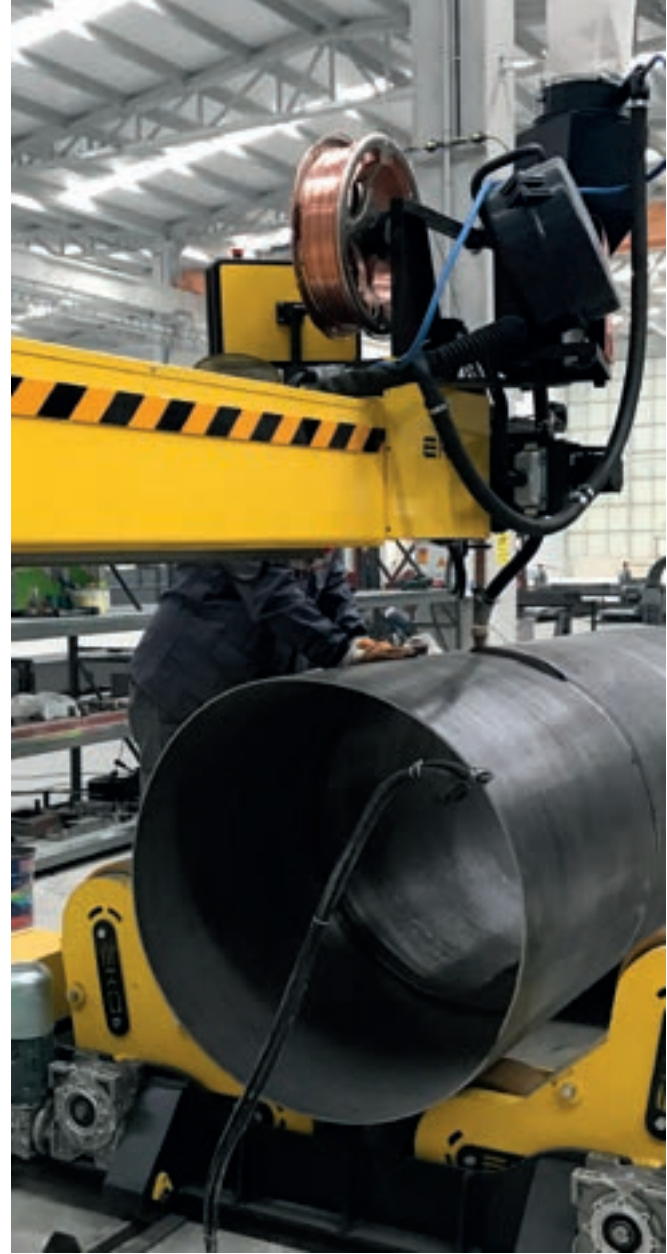
Kolon Bom'un İlerleme Hareketiyle Dış Boy Kaynağı
