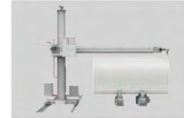
Kolon bom'un ilerleme hareketiyle dış boy kaynağı
