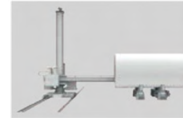
Kolon bom'un ilerleme hareketiyle iç boy kaynağı
