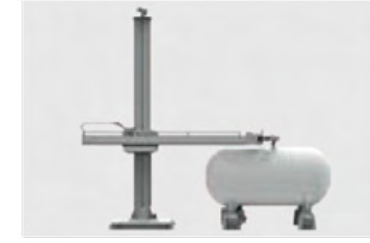
Çift kaynak başlığı ile dış dairesel kaynak (çevirici ile)
